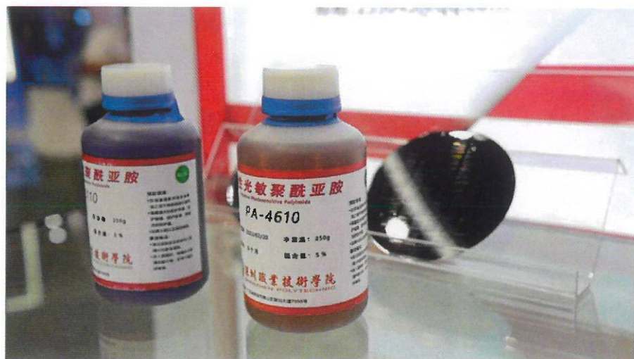
图 2 半导体先进封装用光敏性聚酰亚胺 (PSPI) 光刻胶材料
